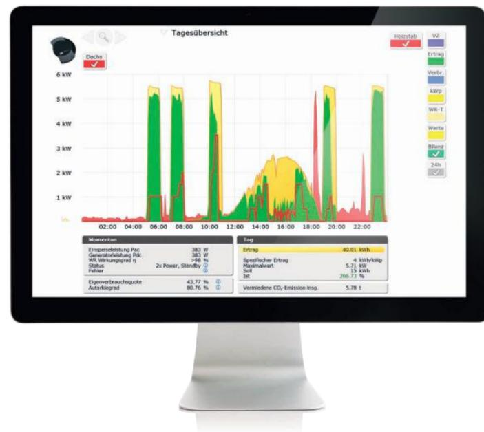
Tagesübersicht Gerät mit Kraft-Wärme-Kopplung und Heizstab
